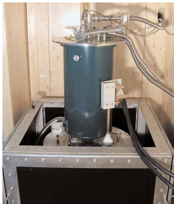
Abb. 1: Ansicht der 50 T-Pulsfeldanlage mit Helium-Kryostat zur Probenaufnahme (oben), Stickstoffkryostat (unten) für die Impulsspule und Berstschutz. Fig. 1: View of the 50 T pulsed field equipment with Helium cryostat for sample cooling (upper) and nitrogen cryostat for cooling of the pulsed magnetic field coil. The burst protection is also visible.
